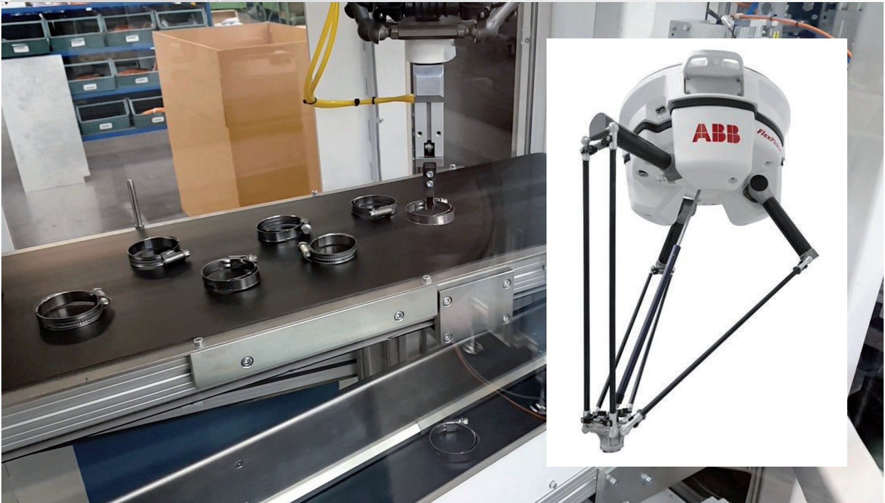
Roboter greift Rohrschellen vom laufenden Band / Robot picks up pipe clamps from the moving conveyor belt.
